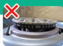
取付位置がずれた状態
