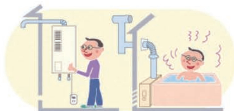
半密閉燃焼式 ガス瞬間湯沸器・ガスバーナー付ふろがま
